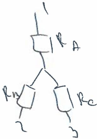
$$R_A = \frac{R_1 R_3}{R_1 + R_2 + R_3}$$
