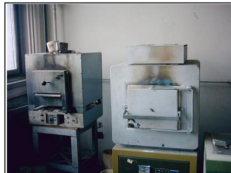
Fig. 4. Cuptor de topire cu bare de superkantal la 1600 °C cu sistem de control termic “on line” tip Nabertherm / C42.
