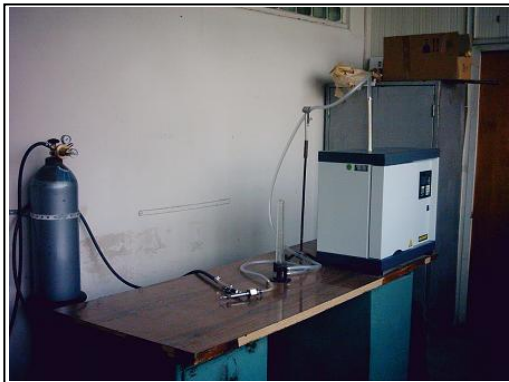
Fig. 4. Cuptor de topire cu bare de superkantal la 1600 °C cu sistem de control termic “on line” tip Nabertherm / C42.
