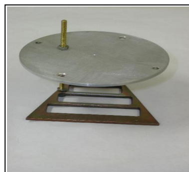
Fig.9. Măști depunere contacte și substrat sensibil la CO.
