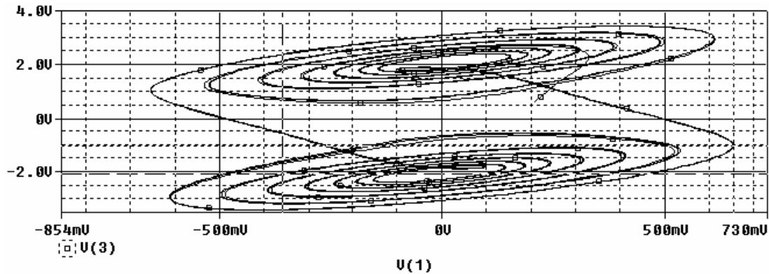
Unui răspuns haotic al unui circuit autonom îi sunt specifice: *caracterul aleator, dependența puternică de condițiile initiale* și un *spectru de bandă largă*. De exemplu, pentru  $R=1,81818K\Omega$  și  $i_L(0)=1,81mA$ ,  $u_{C1}(0)=222V$ ,  $u_{C2}(0)=-2,286V$   $u_{C2}(t)$  are forma din figura de mai jos, iar schimbând  $u_{C1}(0)=222014V$  se obține  $u_{C2}(t)$  din figura următoare.
