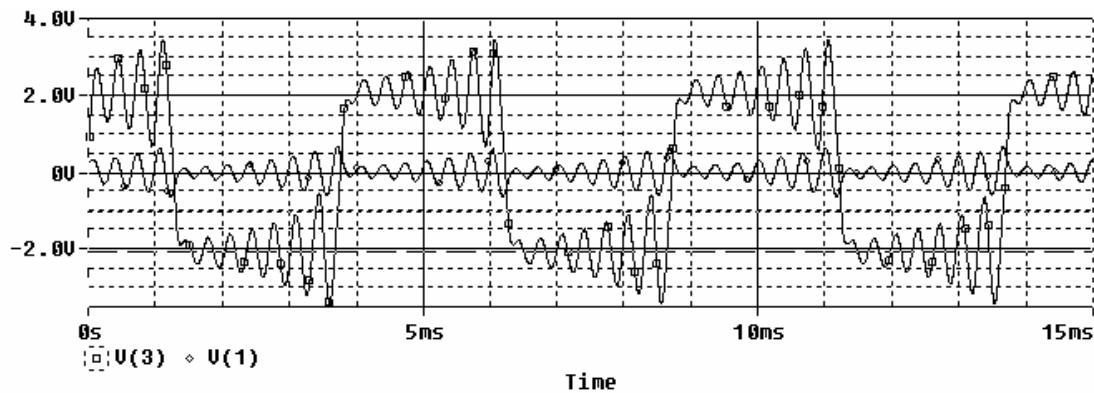
Tensiunile  $u_{C1}$  ( $V(3)$ ) și  $u_{C2}$  ( $V(1)$ ) pentru  $R=1,73 \text{ K}\Omega$  par a fi analizate separat, marimi periodice. Comportarea haotică se observă din graficul dependenței între aceste tensiuni.
